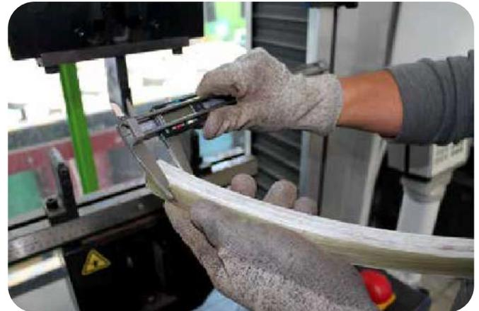
**Deflexión anular a largo plazo:** Para asegurarse del correcto funcionamiento de la tubería de PRFV a largo plazo (50 años) se realiza una prueba para determinar la resistencia a la deflexión anular. El tubo es sumergido en un medio acuoso y bajo una carga constante hasta llegar al nivel de deflexión A de la deflexión anular inicial sin presentar fallas. Este ensayo se realiza de acuerdo a la norma ASTM D5365.
